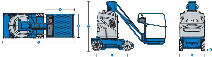
(1) Altura de trabajo = Altura de la plataforma + 2 m
