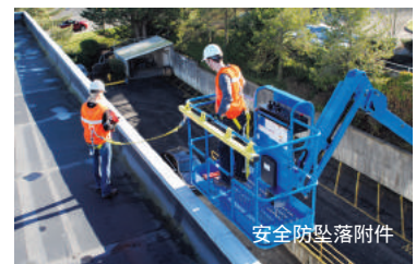
Genie Lift Guard™ 操作者警报系统
