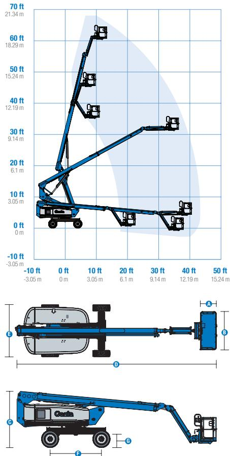
(1) 公制工作高度等于平台高度加 2 米。英制是平台高度加 6 英尺。
