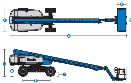
(1) No sistema métrico, altura de trabalho = altura da plataforma + 2 metros
