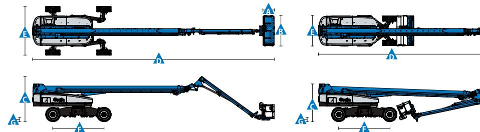
\* 作業高さのメートル換算値は、作業台高さに2mを追加。米国単位では、作業台高さに6フィートを追加。
