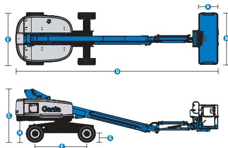
(1) En el sistema métrico, altura de trabajo = altura de la plataforma + 2 m.
