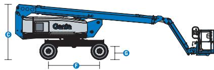
(1) En el sistema métrico, altura de trabajo = altura de la plataforma + 2 m.
