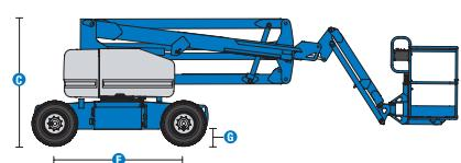
(1) 公制工作高度是平台高度加2米, 英制工作高度是平台高度加6英尺。
