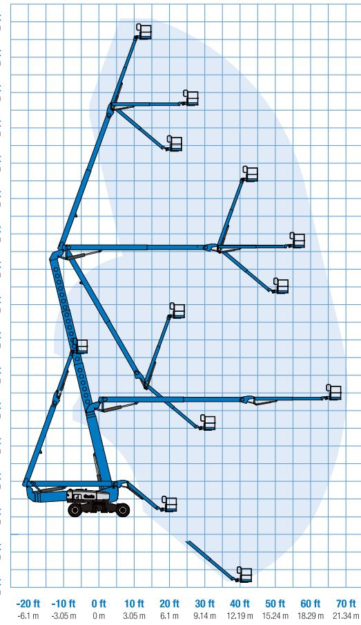
\* メートル法での作業対象の高さには作業台の高さに 2 m を加算してください。米国の場合には作業台の高さに 6 ft を加算してください。
