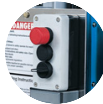
Función de descenso auxiliar de la plataforma
